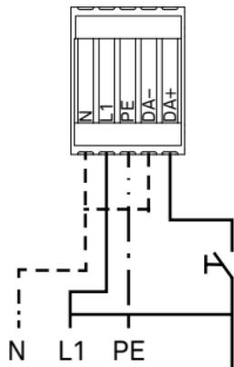
**DE** Anschlussschema für PhasenDim-Betrieb
